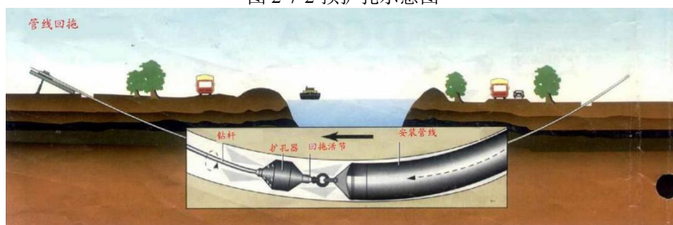
图 2-7-3 管道回拖示意图
