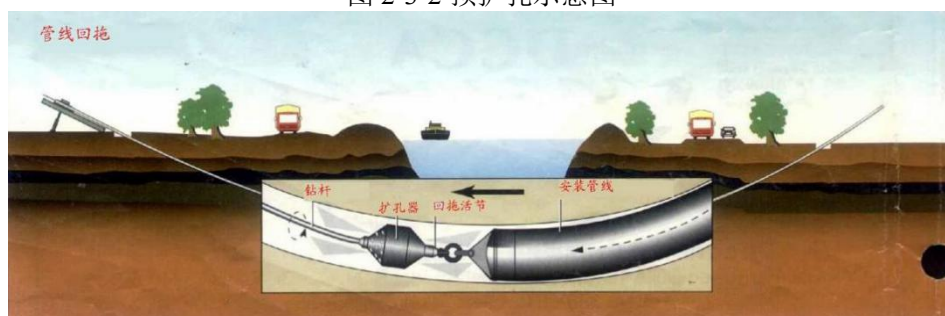
图 2-3-3 管道回拖示意图
